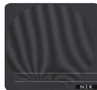
直徑為1,000μm的光纖在光學顯微鏡下的圖像。 1條線條 = 0.01°
